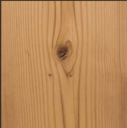
gebürstet: feine Struktur, Bearbeitung mit Kunststoffbürsten
