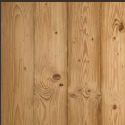
tiefengebürstet: grobe Struktur, Bearbeitung mit Metallbürsten
